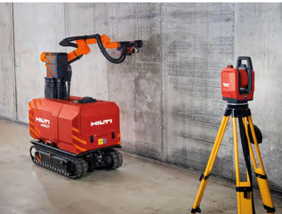
Der Jaibot mit dem automatisierten Absteckgerät PLT 300 bei einer Wandbohrung.
