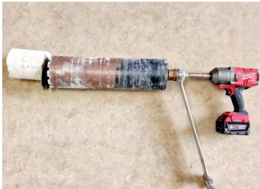
Core-Pusher im Einsatz: Mit einer Gewindestange schiebt sich der Kern aus der Krone.
