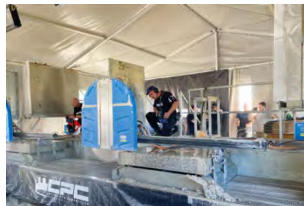
Drei Disziplinen werden ausgetragen: Beim Ringsägen (l.) muss ein Betonrohr so schnell wie möglich durchgeschnitten werden, beim Wandsägen (r.) ist neben Geschwindigkeit auch etwas Fingerspitzengefühl notwendig und ...
