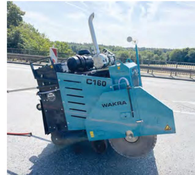
Der C160 von Wakra: ein lenkbarer Dieselfugenschneider im Nassschnittverfahren.
