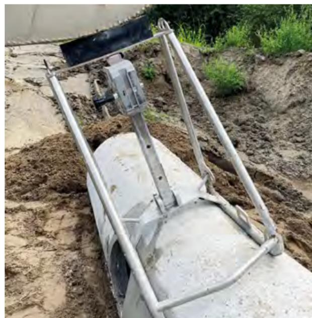
Kernbohrgerät DD300 zum sicheren Positionieren von Kernbohrmaschinen am Bohrobjekt.
